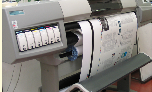
Kontrolle der Druckdaten – Plot einer Bogenform
